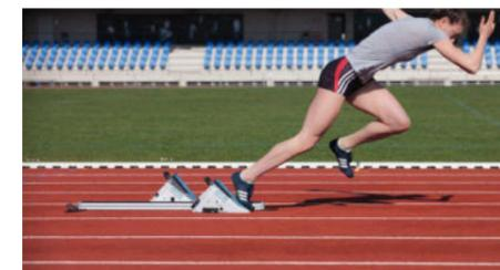
**KiSprint system:** 一场完美的赛跑始于一次完美的起跑。使用正确的技术至关重要，这样运动员才能在最初几米内释放出最大的能量。我们提供的短跑测力起跑器可以测量短跑起跑时蹬力的变化过程；激光可以捕获速度；高速摄像机则可以提供同步视频数据。
