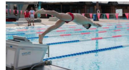
**KiSwim system:** 用测力出发台、测力转身板和高速视频来测量游泳运动员训练时的关键表现参数。教练和运动员可以以生物力学表现分析数据的形式立即获得关键反馈。他们可以根据这些输入信息对下一次训练作出修正——然后在下一次竞技体育赛事中获得至关重要的百分之一秒的领先优势。
