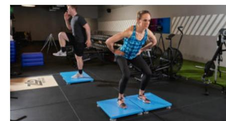
**KiJump & Quattro Jump systems:** 定期的体能测试可以让教练和治疗师真实地评估运动员或患者的个人表现能力。通过对跳跃力、速度、耐力和稳定性等进行分析可以提供实现这一目标所需的客观数据。我们提供两个 1 维或 3 维测力台测量两条腿的发力情况，并进行左右比较。
