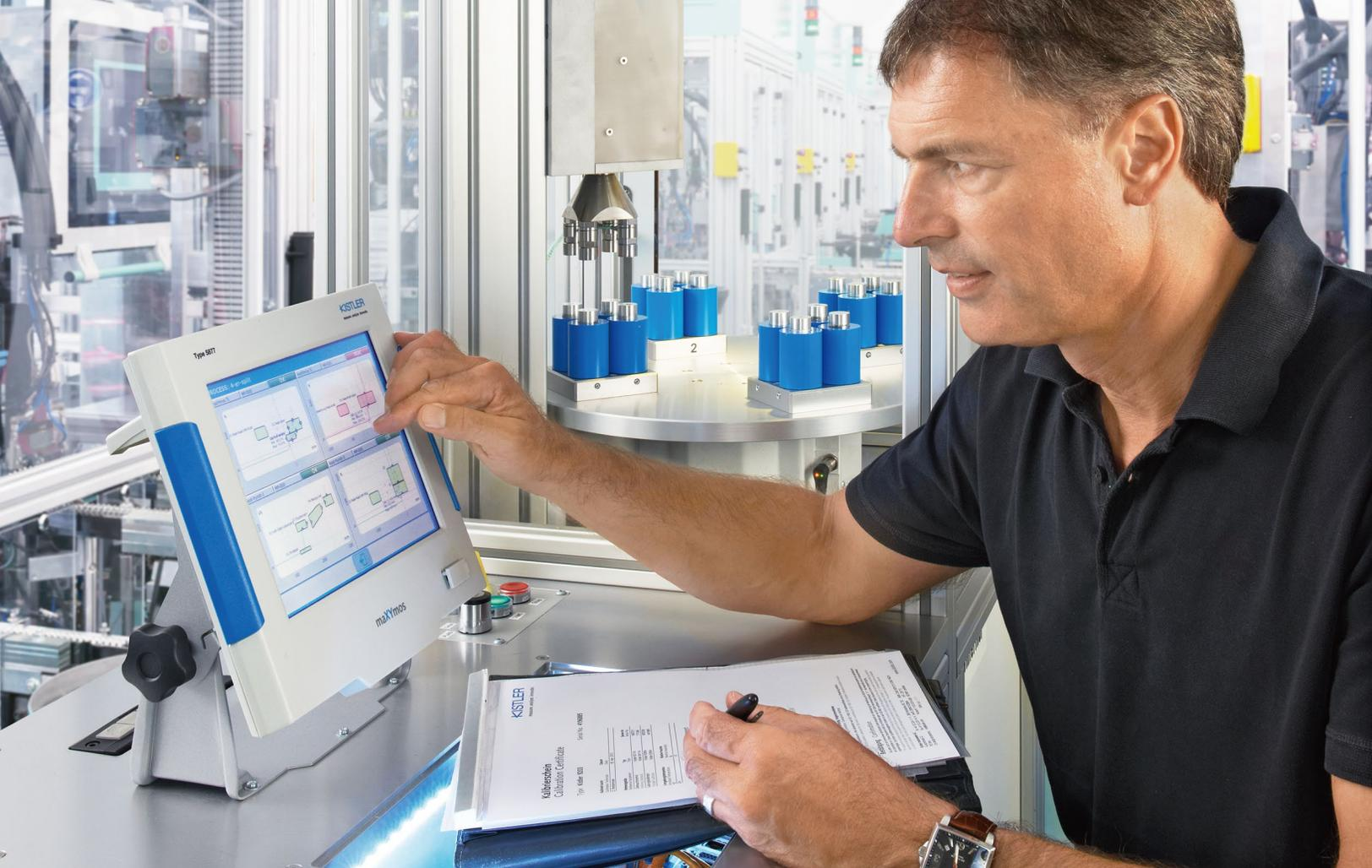
奇石乐的力 - 位移监测仪记录和评估相互关联的两个被测量的力 - 位移曲线。
