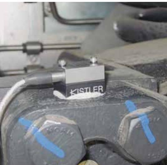
8315A型单向加速度计用于电车的预防性维护
