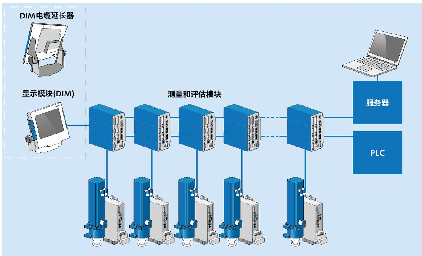
可级联8对XY通道。MEMs安装在控制柜中。DIM作为中心可视化系统并通过5米电缆直接连接。DIM电缆延长器可覆盖更远的距离。
