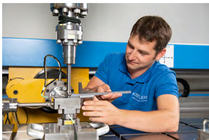
多成分の力の校正: シリンダ位置の測定
