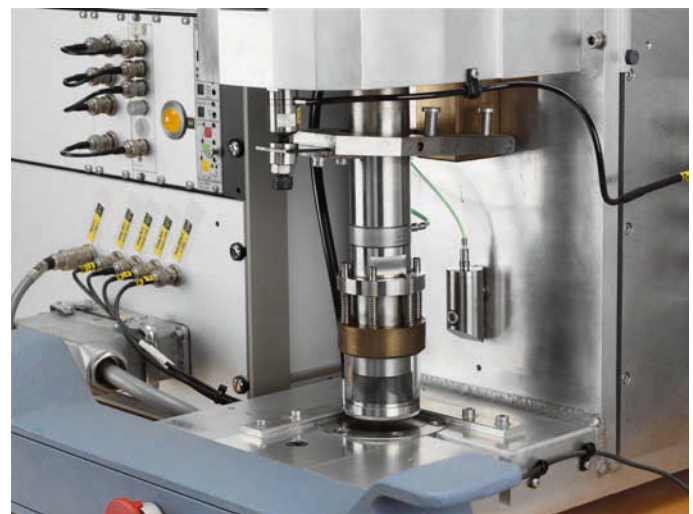
使用表面应变传感器进行间接测力
