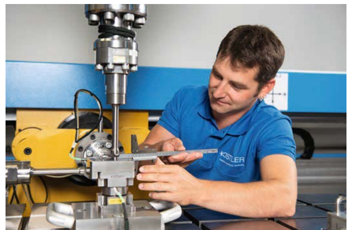
多分量力校准：测量气缸的位置
