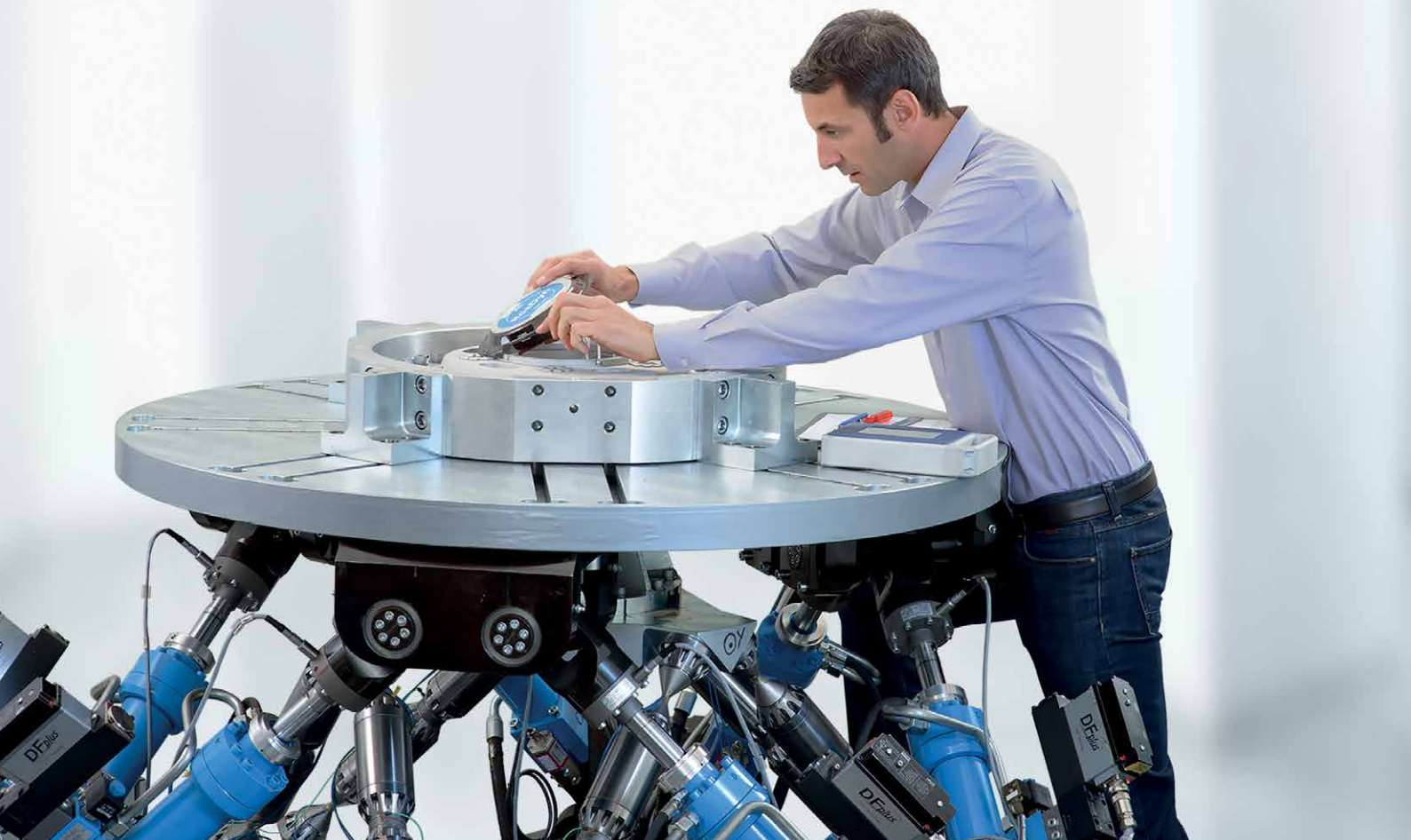
Kalibrierung eines RodDyn Radkraftsensors am Hexapoden-Messstand
