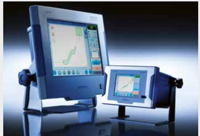
XY-Monitoring mit maXYmos TL (Top Level) und maXYmos BL (Basic Level) zur In-Prozess-Qualitätsüberwachung und Produktprüfung beim Fügen und Montieren
