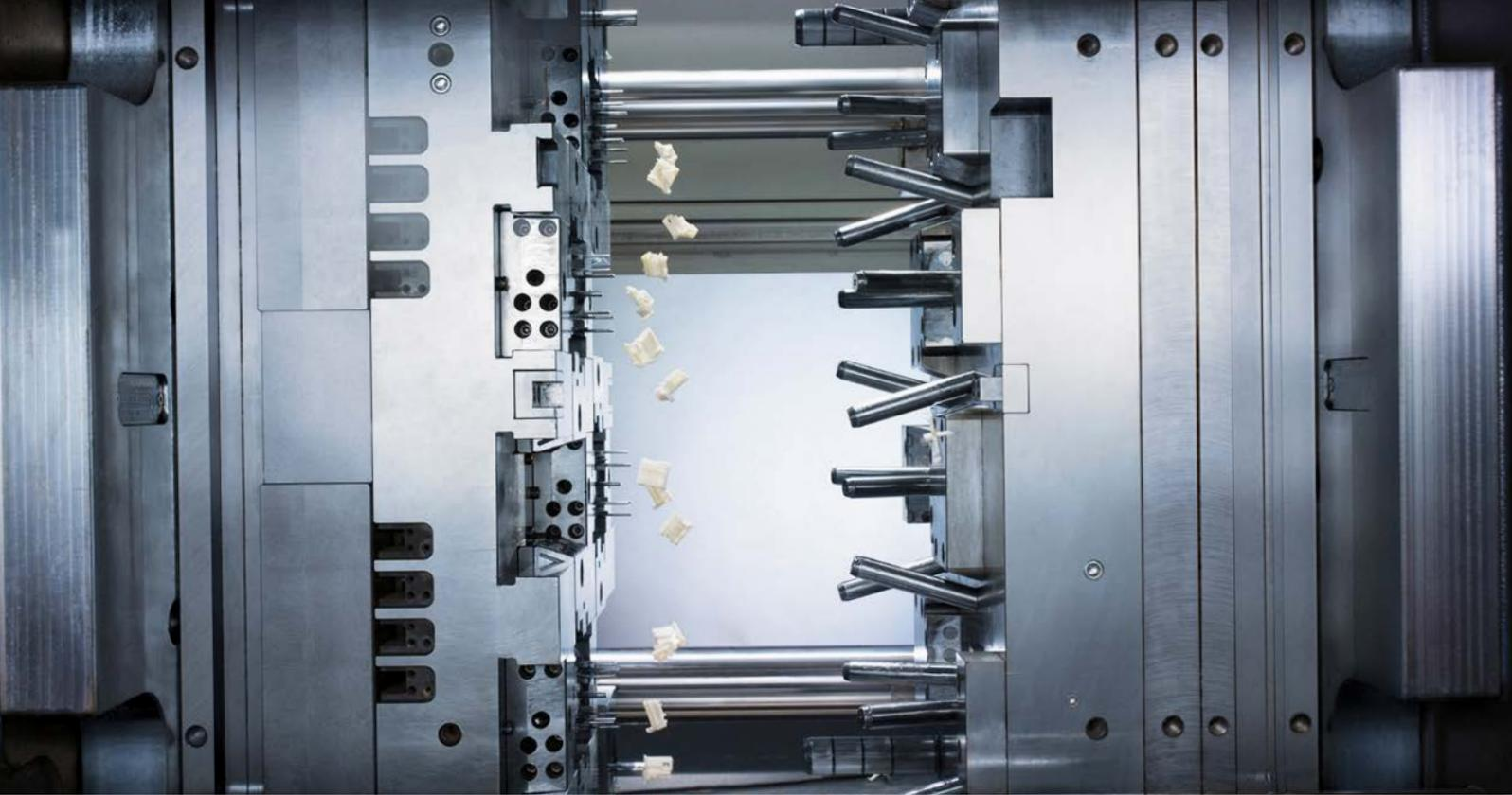
Die Überwachung des Werkzeuginnendrucks beim Spritzgießen reduziert die Kosten für die Qualitätssicherung.
