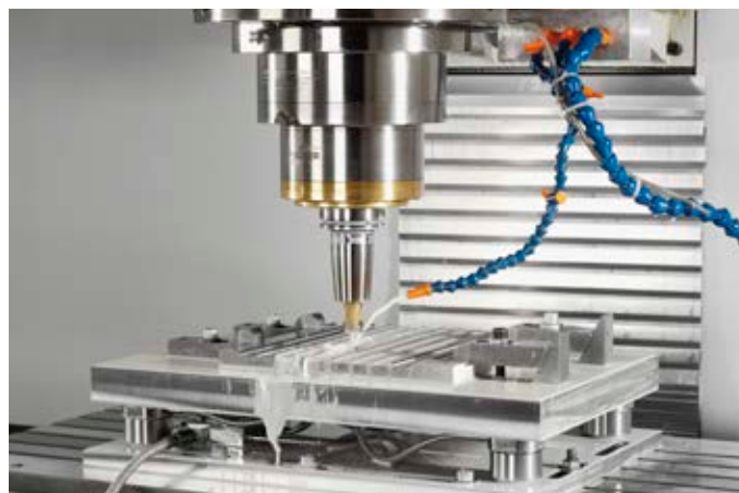
動力計 (型式 9366CC) を使用したチタン合金の切削力測定
