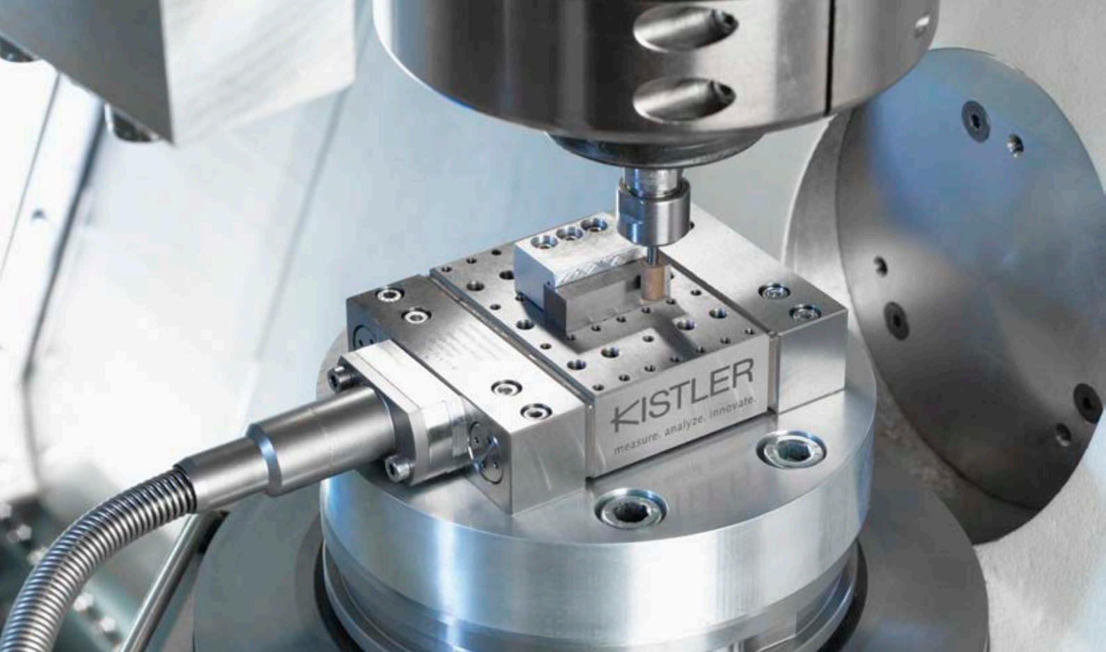
動力計（型式 9129AA）を使用した研削加工
