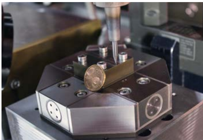
マイクロ加工用マシニングセンタに取り付けた MicroDyn 9109AA
