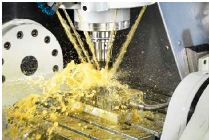
動力計 (型式 9129AA) を使用したフライス加工
