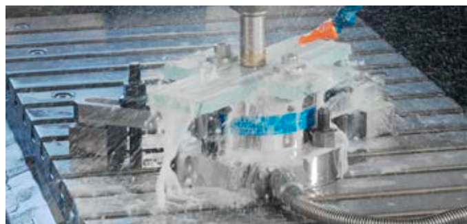
動力計 (型式 9272) を使用した、水晶の切削力測定
