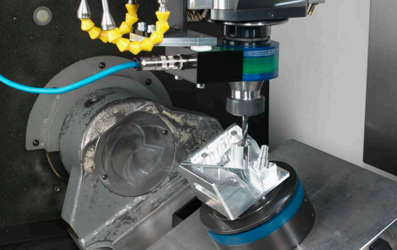
回転式動力計（型式 9170A）を使用した穴あけ
