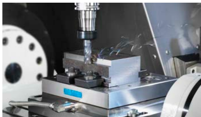
動力計 (型式 9255C) を使用したフライス加工
