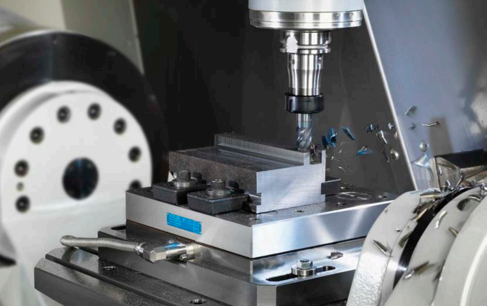
動力計（型式 9255C）を使用した高合金鋼のフライス加工
