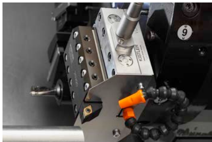
動力計 (型式 9129A) を使用した旋盤加工
