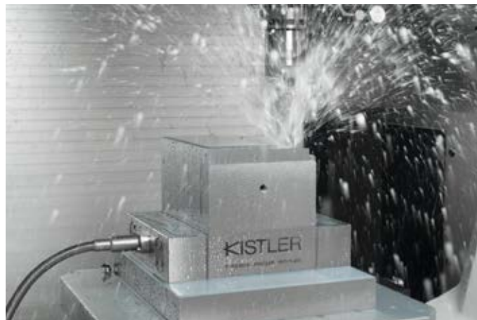
動力計 (型式 9139AA) を使用したフライス加工
