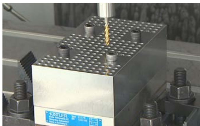
動力計 (型式 9257B) を使用したネジ切り
