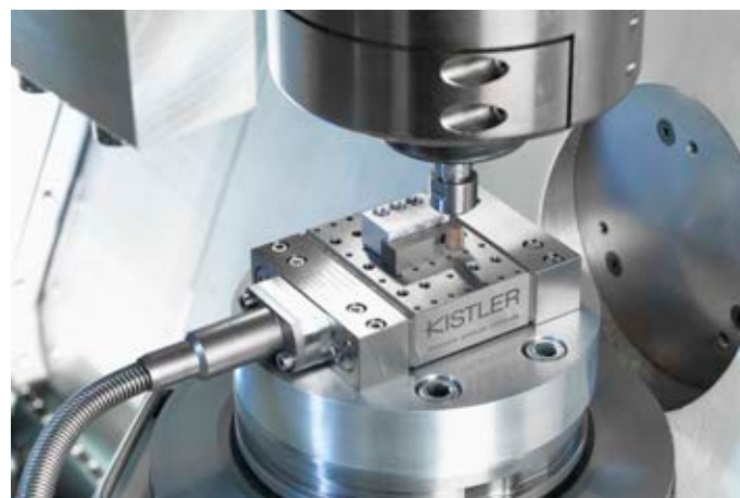
動力計 (型式 9119AA2) による研削加工時の力測定
