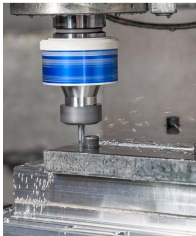
回転式動力計（型式 9170B）を使用したフライス加工
