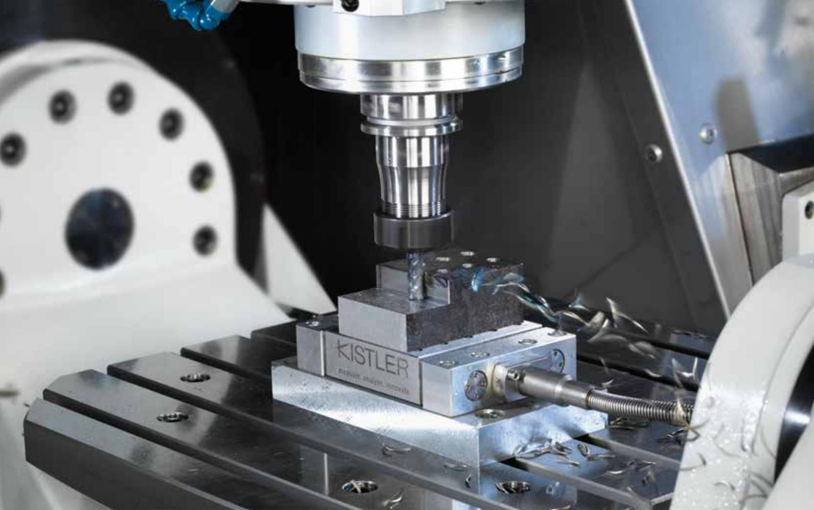
固定式動力計(型式 9129AA)を用いたフライス加工
