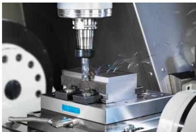
動力計 (型式 9255C) を使用したフライス加工
