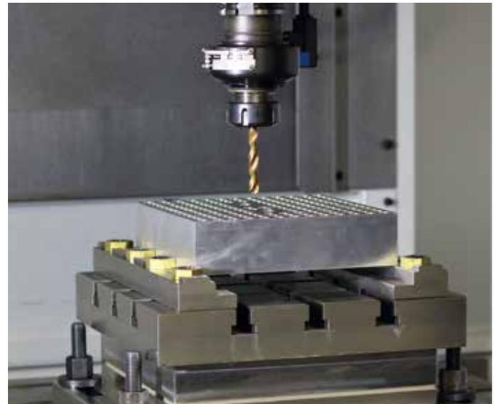
稼働中の MITIS システム：キスラーの動力計（型式 9255C）の上にワークが取り付けられた状態
