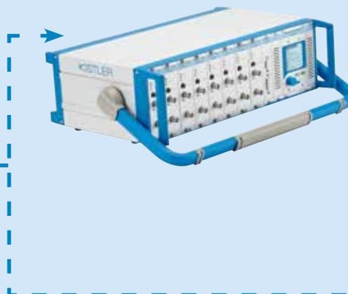
動力計は、各測定構造の中核を成すシステムです。測定対象の物理的パラメータを把握し、その情報を電荷信号の形でチャージアンプに転送します。その際に使用するものは、多くの場合は工作テーブルに取り付けられた固定式動力計か、または主軸インタフェースを介して主軸に組み込んで取り付けられた回転式動力計です。
