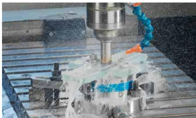
動力計 (型式 9272) を使用した、水晶の切削力測定
