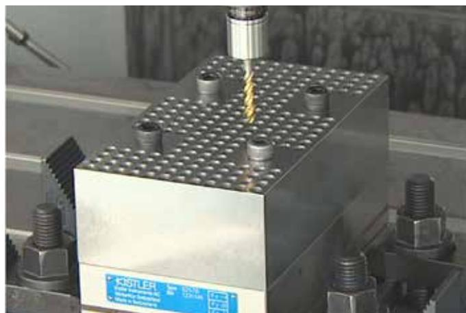
動力計 (型式 9257B) を使用したネジ切り
