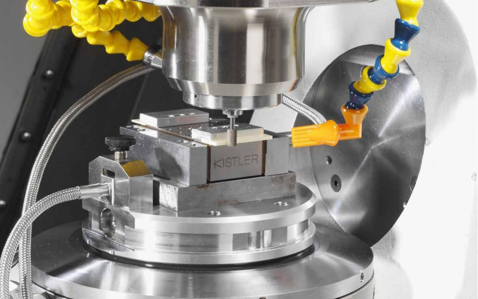
動力計 (型式 9129AA) を用いた研削加工
