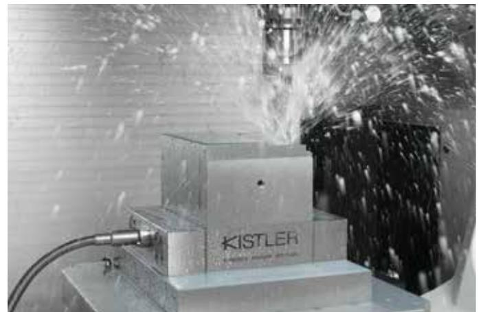
動力計 (型式 9139AA) を使用したフライス加工
