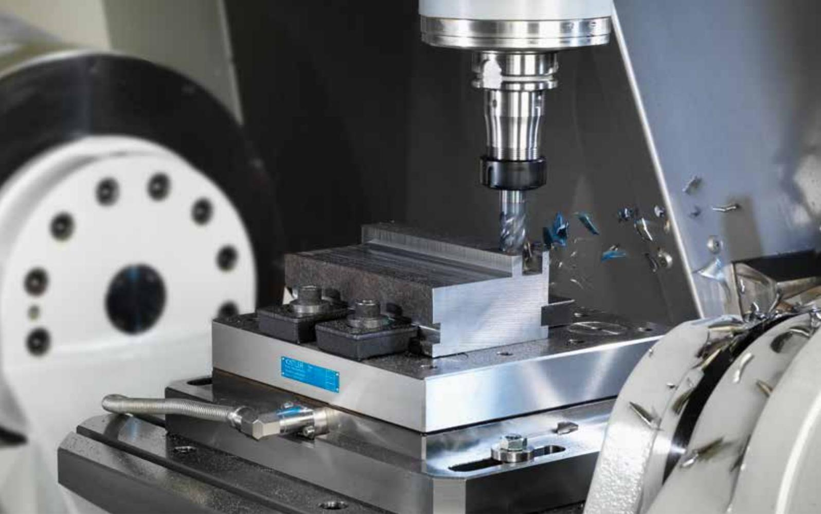
動力計 (型式 9255C) を用いた高合金鋼のフライス加工
