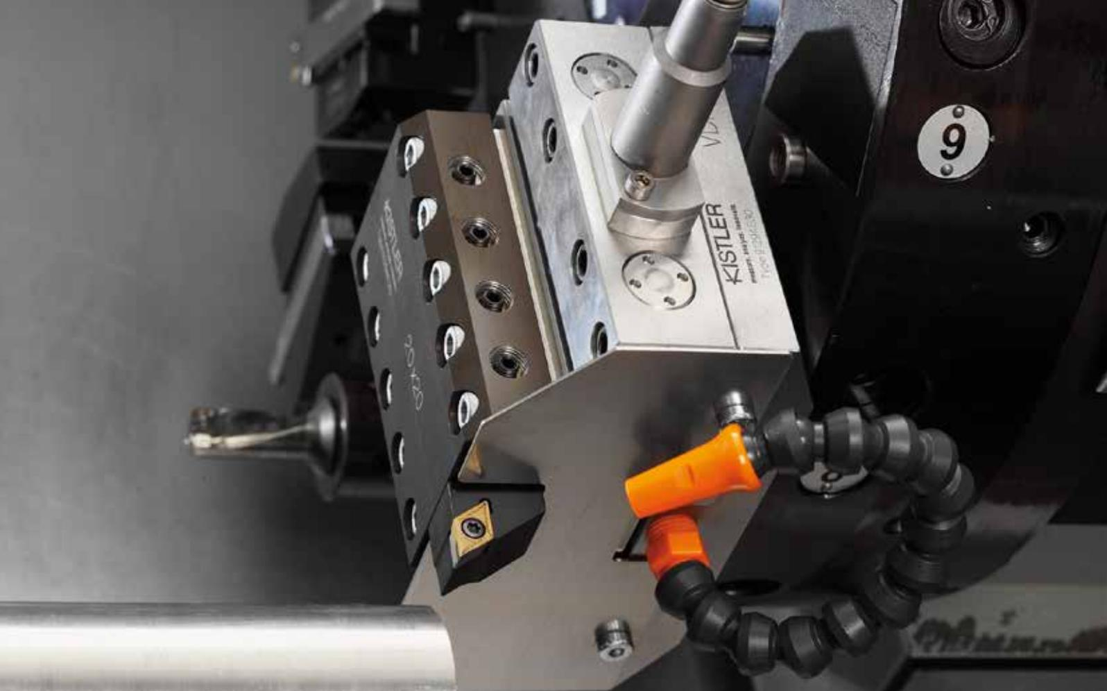
動力計 (型式 9129AA) を用いた旋削加工
