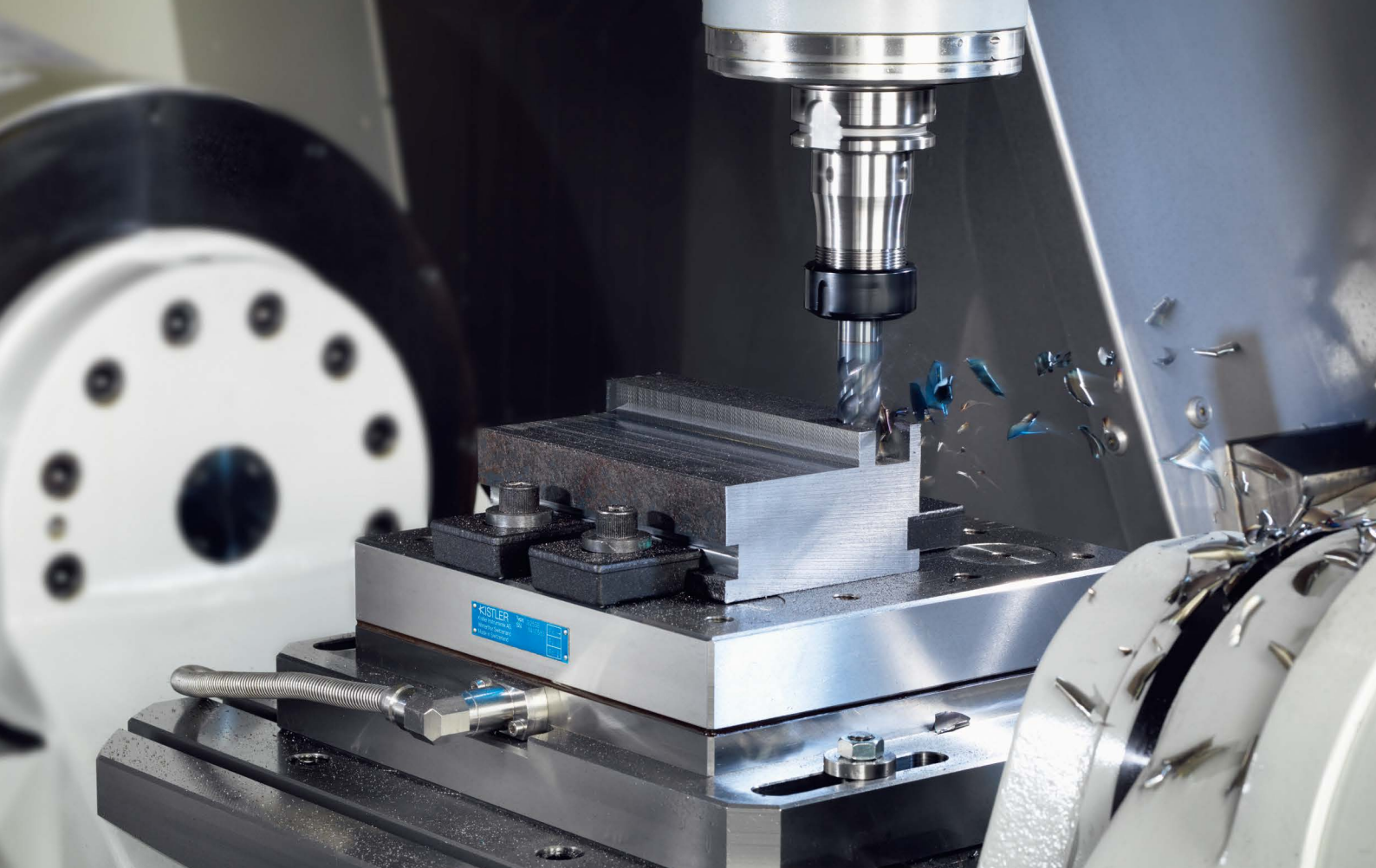
使用9255C型测力计用于高合金钢铣削测量
