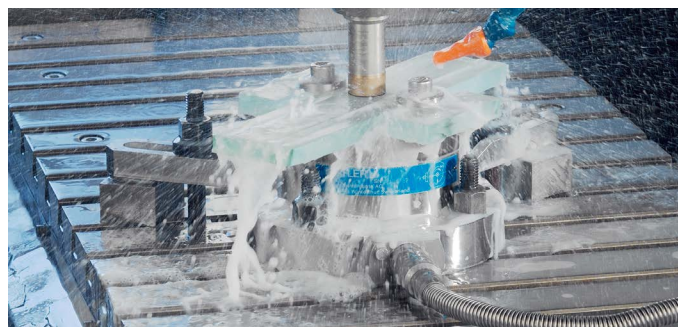
9272型测力计用于石英切削时的测量
