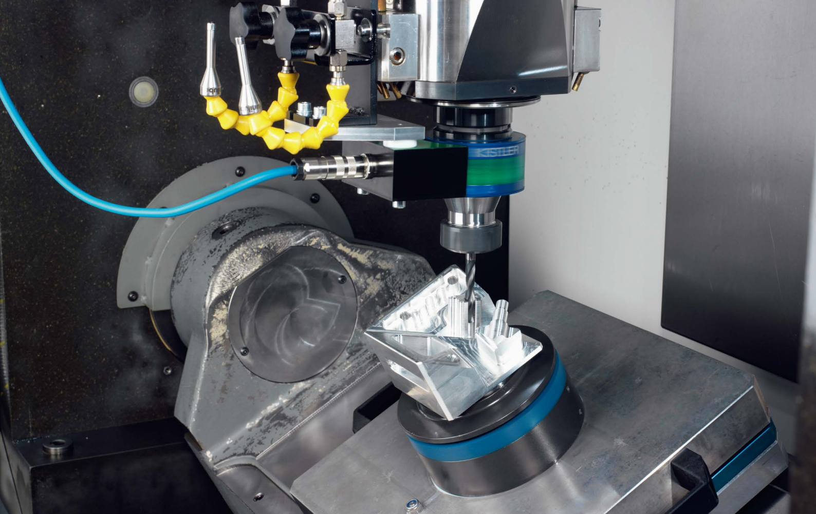
用于钻削力测量的9170A型旋转测力计
