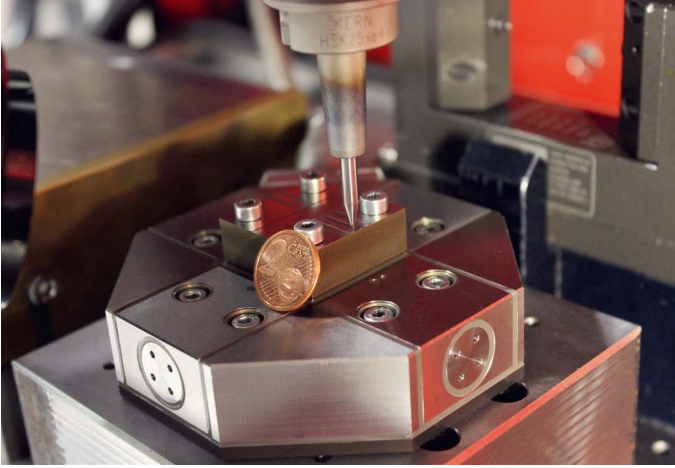
用于微细加工中微小力测量的MicroDyn 9109AA
