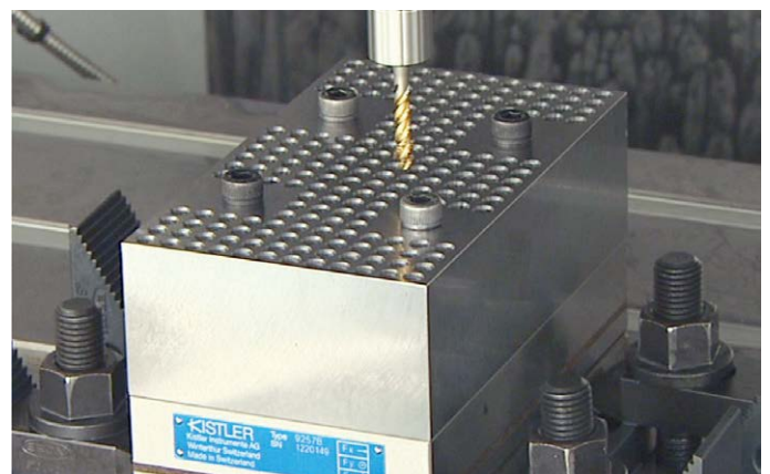
9257B型测力计用于螺杆攻丝
