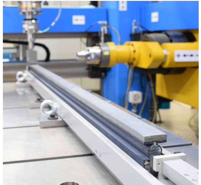
Die Qualität jedes einzelnen Sensors wird vor Auslieferung mit Hochpräzisionswerkzeugen geprüft.
