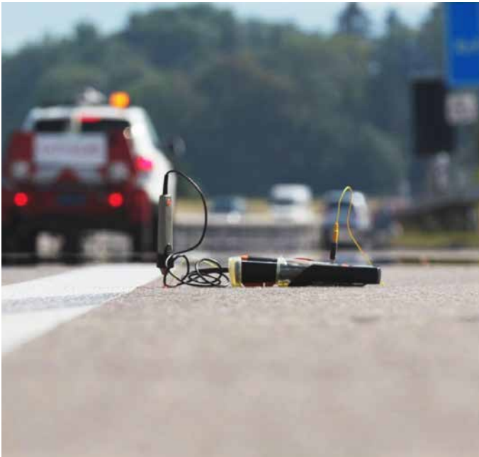
Structural Road Analysis (SRA) – die Analyse des strukturellen Zustands von Straßen – trägt wesentlich zur Bestimmung des idealen Einbauorts einer WIM-Lösung bei.
