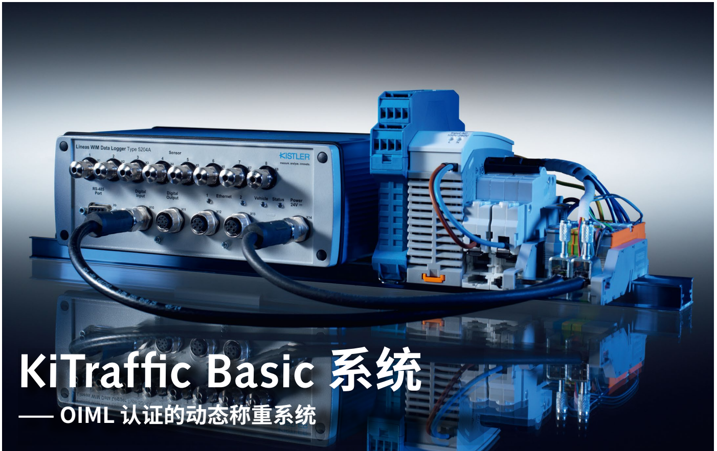
KiTraffic Basic 系统包括数据采集仪、车检器和电源模块，所有这些设备都预先连接在DIN导轨上，可以轻松的设置操作。
