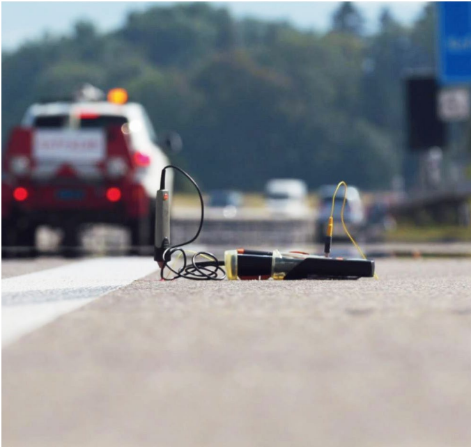
结构道路分析(SRA)是确定动态称重系统安装理想位置的关键。
