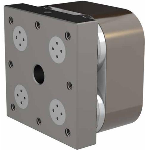
Das SmartCrash-Kraftmesselement wird werkskalibriert ausgeliefert und ist sofort nach der Montage einsatzbereit. Die Spannungsversorgung des SmartCrash-Kraftmesselements erfolgt durch die externe Stromversorgung des Datenrekorders.
