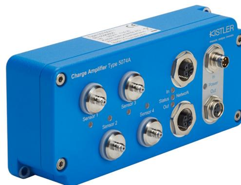
されています。切替え可能なハイパスフィルタ<sup>1)</sup>により、連続動作中でも測定を中断することなく高速な工程監視ができます。アナログ測定値はチャージアンプ内でデジタル化され送信されます。チャージアンプ内での電氣的絶縁と併せ、早期デジタル転送化により、マスターシステムに測定値をノイズの影響なく確実に伝送可能です。
