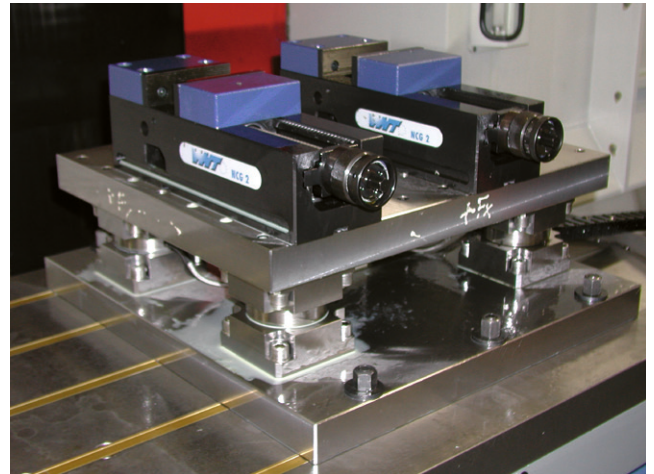
Abb. 1: Beispielhafter Anwendung eines 3-Komponenten Kraftaufnehmers, hier am Beispiel des Typen 9347C/9348C
