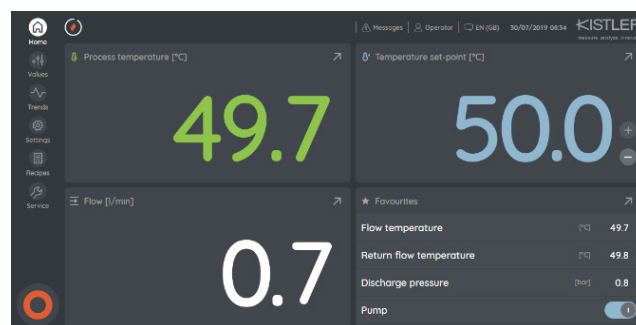
図1：型式2621Gのユーザーインターフェイス
