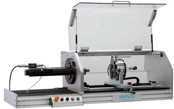
Horizontale mechanische Vorrichtung mit optionaler Antriebsspindel und Sensorik
