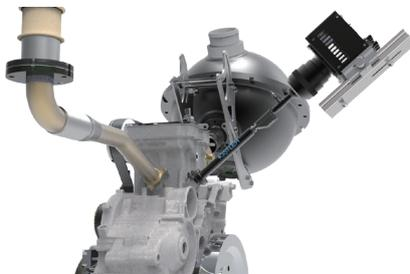
図1: 単一シリンダーに適用される高速度カメライメージングシステムの基本レイアウト
