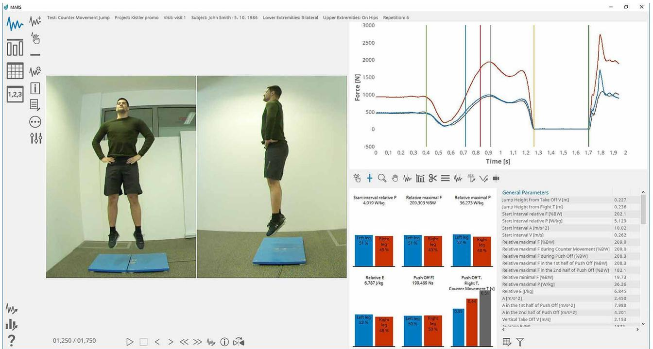
Abb. 1: Analyse-Sicht mit Video, Kraft-Zeit-Kurve, Grafische Darstellung von links/rechts, Parameterliste
