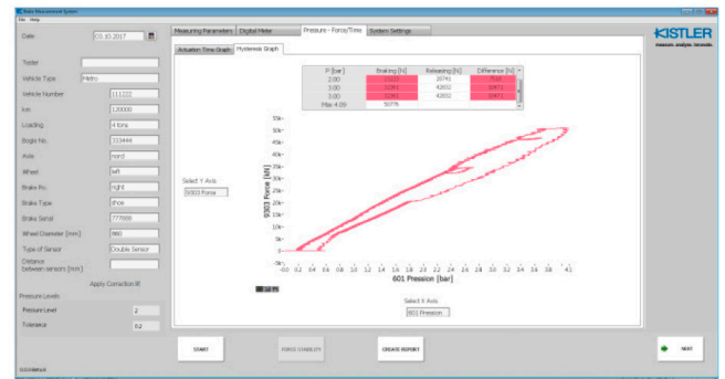
Abb. 2: Die anwendungsspezifische Bremskraft-Analysesoftware zeichnet die gemessenen Signale auf und bestimmt bremspezifische Kennwerte
