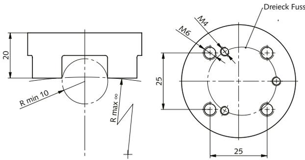
Abb. 6: Montageadapter für Rohre, Ø25... ∞
