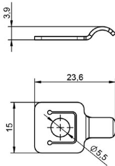
Abb. 8: Montagebride für Hardlinekabel
