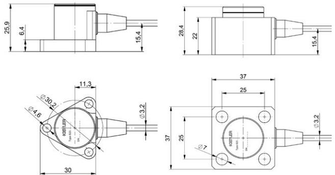
Abb. 1: Abmasse des Beschleunigungssensors
