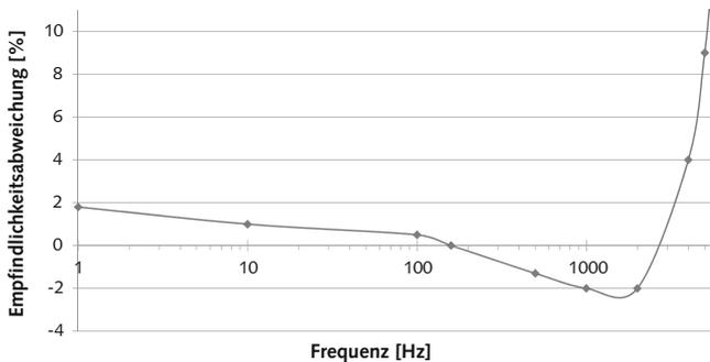
Abb. 3: Typische Frequenzantwort, relativ zur Referenzfrequenz 159 Hz
