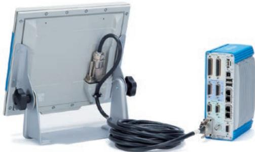
.... oder auch als kompakte Einheit. Dazu wird das MEM in den rückseitigen Slot des DIM geschoben und damit gleichzeitig mechanisch und elektrisch verbunden:
