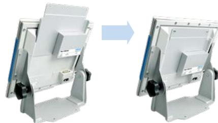
Der DIM Cable Extender ist im rückwärtigen Teil des Displays eingeschoben. Die Speisung des DIM Cable Extenders erfolgt mit 24 V (Display wird dann vom DIM Cable Extender versorgt). Das DIM Cable Extender wird über ein Ethernetkabel an eines oder an mehrere maXYmos verbunden.
