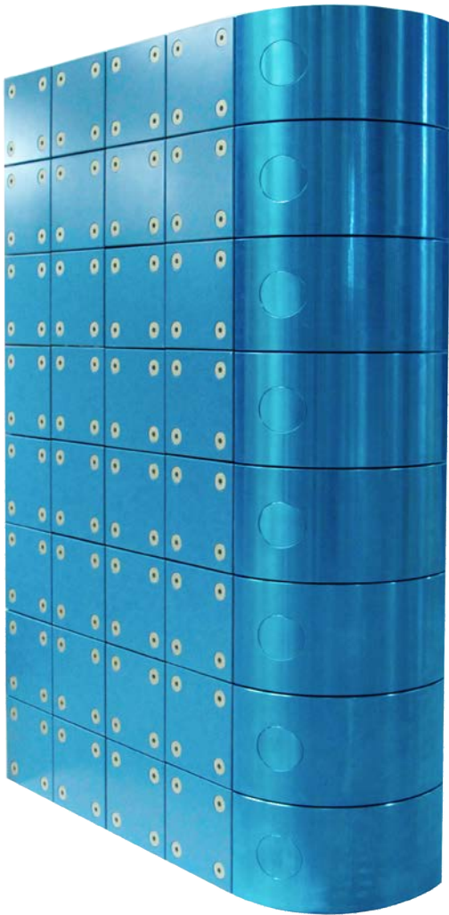
Bild 1: SmartCrash®-Overlap Segment 650x1 000 mm mit 40 Kraftmesselementen
