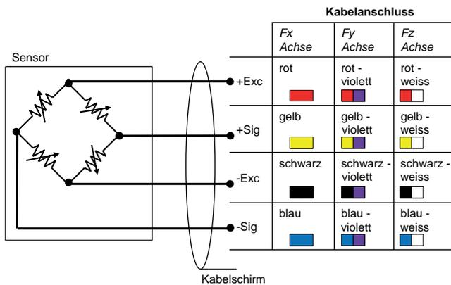
Bild 2: Kabelanschluss
