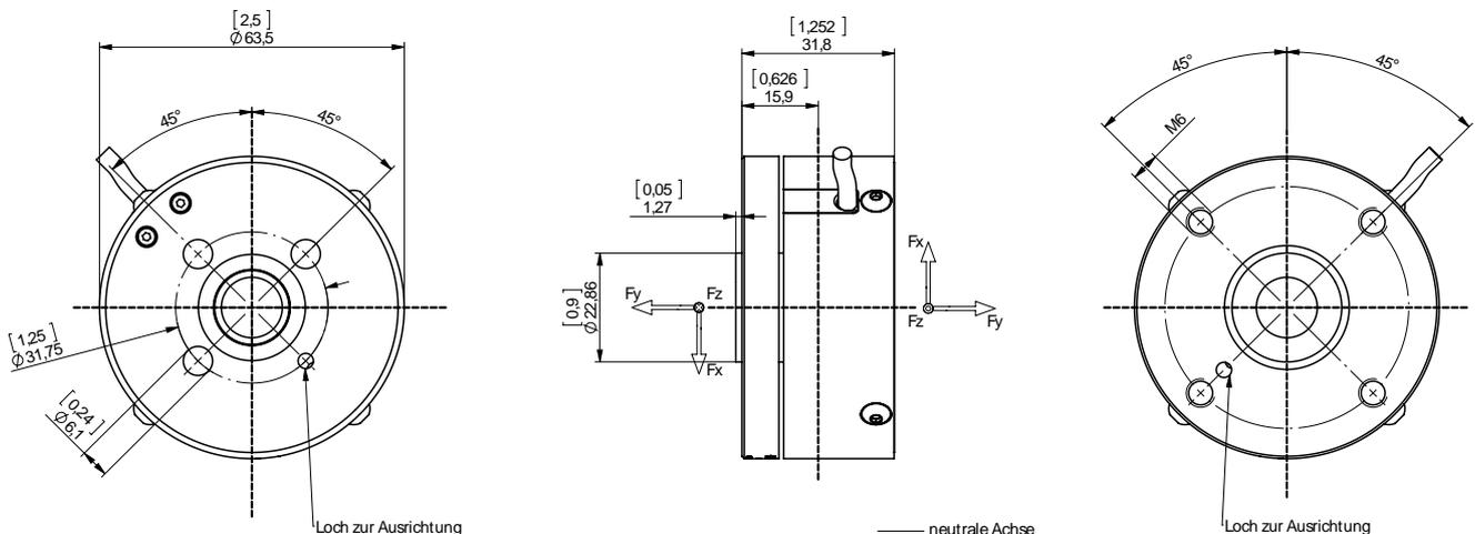
Bild 3: Abmessungen (linke Ausführung) in mm
