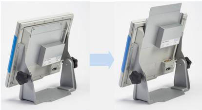
Der DIM Cable Extender ist im rückwärtigen Teil des Displays eingeschoben. Die Speisung des DIM Cable Extenders erfolgt mit 24 V (Display wird dann vom DIM Cable Extender versorgt). Das DIM Cable Extender wird über ein Ethernetkabel an eines oder an mehrere maXYmos verbunden.
