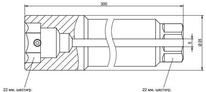
Рис. 10. Монтажный инструмент, пазовый, Тип 1251A25A
