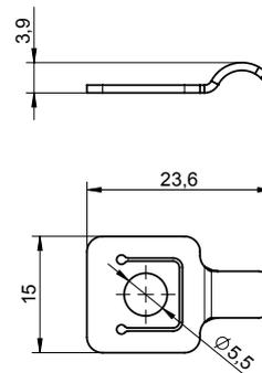
Рис. 9. Монтажный кронштейн для жесткого кабеля, 1423A1
