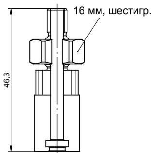
Рис. 8. Съемный инструмент, Тип 6419A25B на монтажной гайке
