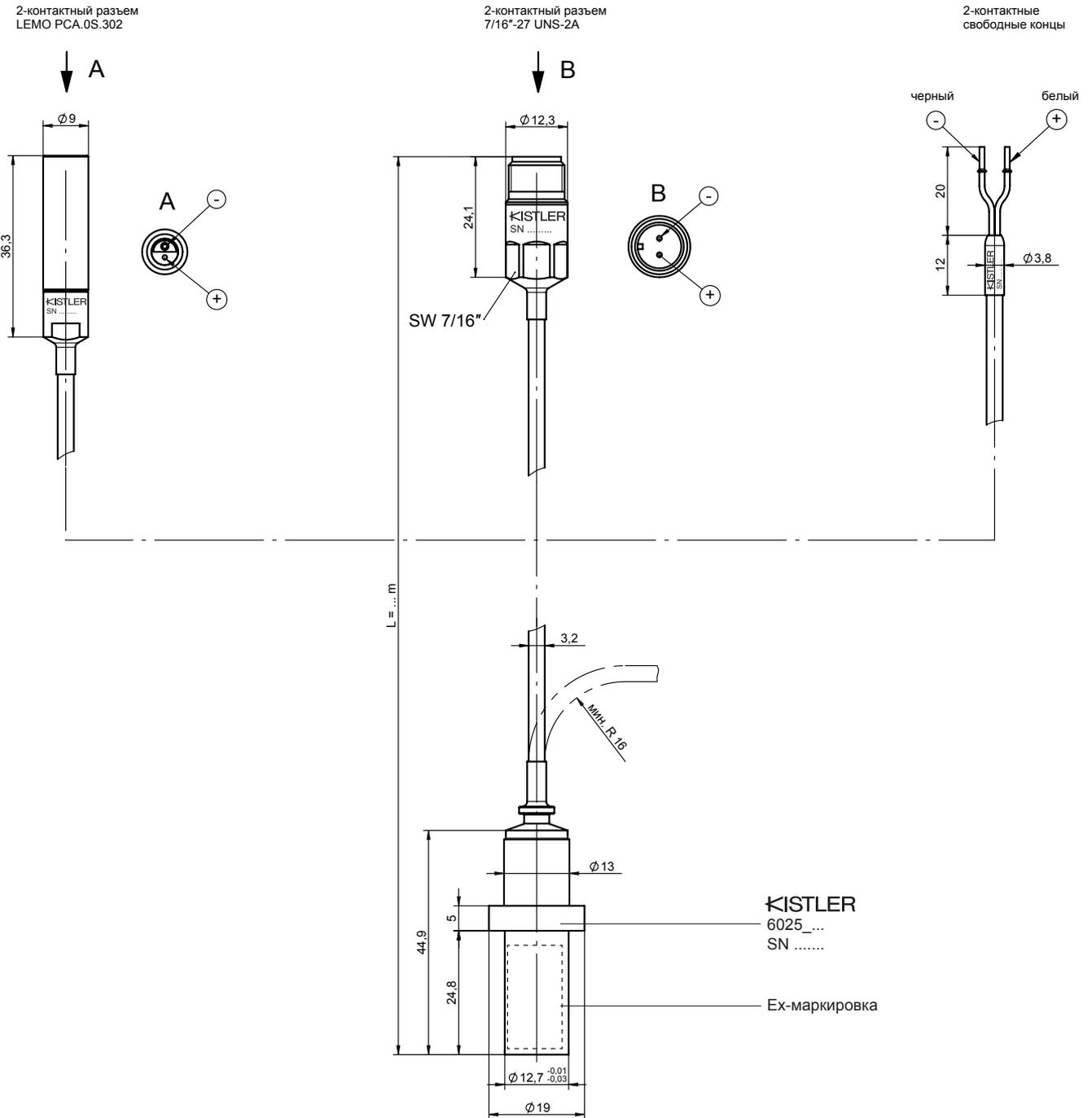
Рис. 3. Размеры датчика типа 6025A..., включая кабельные окончания
