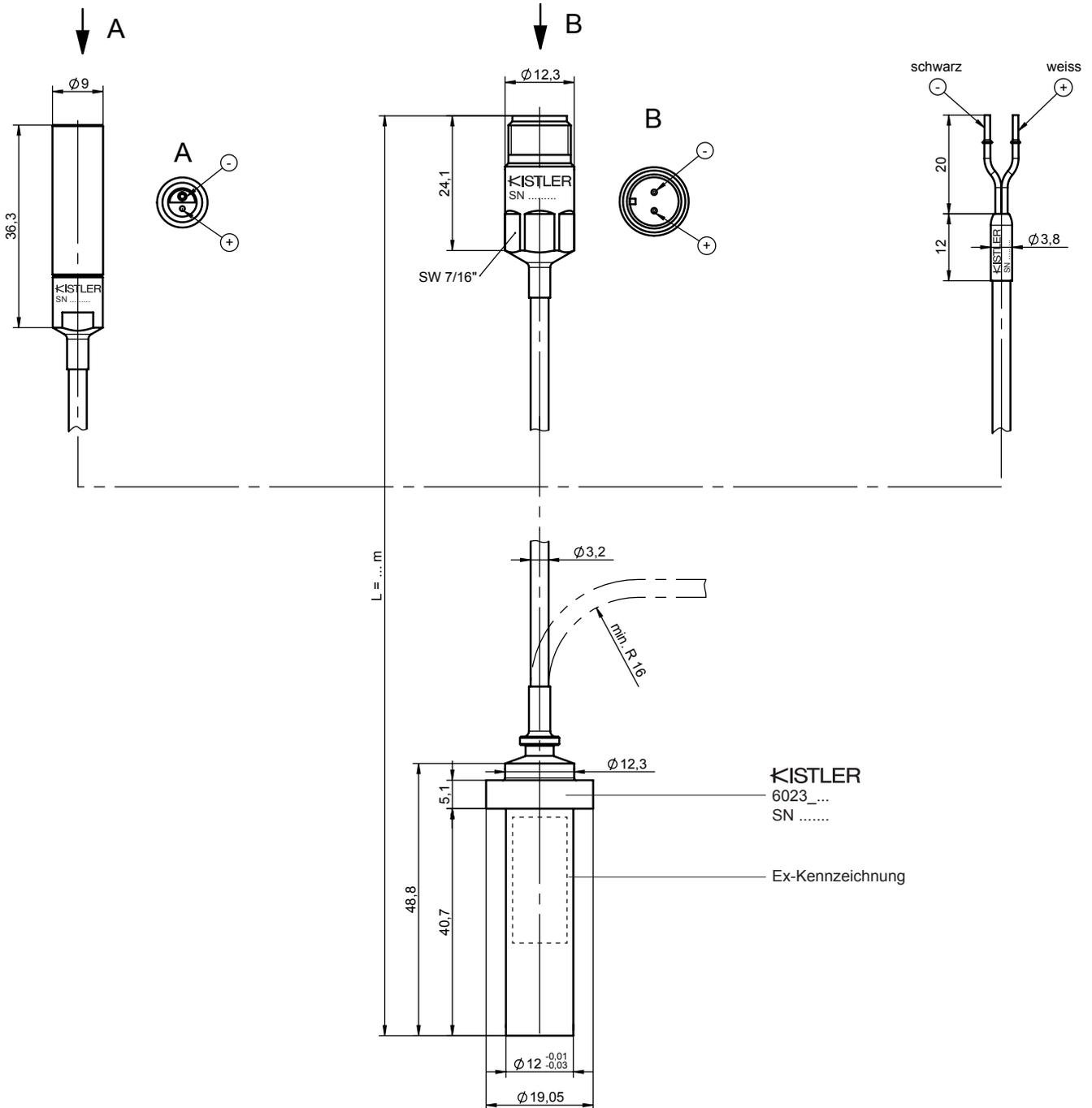
Bild 3: Sensordimensionen Typ 6023A... inklusive Kabelterminierung
