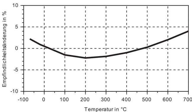
Bild 2: Typische thermische Empfindlichkeitsänderung relativ zur Raumtemperatur
