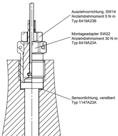
Bild 6: Sensormontage direkt, mit Ausziehvorrichtung Typ 6419A23B
