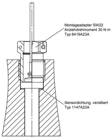
Bild 5: Sensormontage direkt
