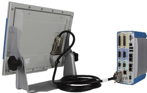
また、一体にして使用することも可能です。この場合は、ディスプレイモジュール(DIM)の裏側にあるスロットに、測定・評価モジュール(MEM)を取付けます。なお、接続ケーブルは不要となります。
