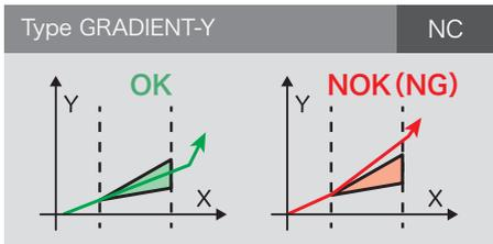
Y軸傾き (GRAD-Y) : Y軸に平行な2本の線間における傾きの度合い  $dy/dx$  を用いて、OK/NOK(NG)の判断が行われます。
