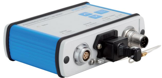
de mesure monocanal simple d'utilisation est particulièrement conseillé pour les applications où des capteurs individuels sont mis en oeuvre et où une précision de mesure de très haut niveau est exigée. Par exemple lors de mesure sur des systèmes embarqués dans le véhicule ou pour des tâches de mesure exigeantes en laboratoire de mesure.
