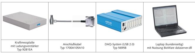
Bild 2: Konfiguration einer typischen Messkette mit dem DAQ-System mit BioWare dataserver.dll
