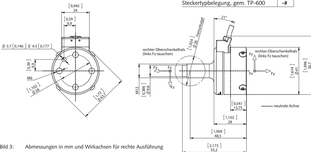
Bild 3: Abmessungen in mm und Wirkachsen für rechte Ausführung
