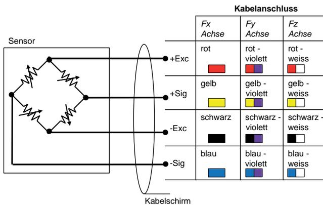
Bild 2: Kabelanschluss
