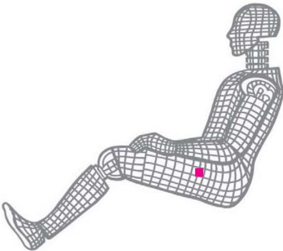
Bild 1: Dummyanwendung, Messstelle Femur und Femur Neck
