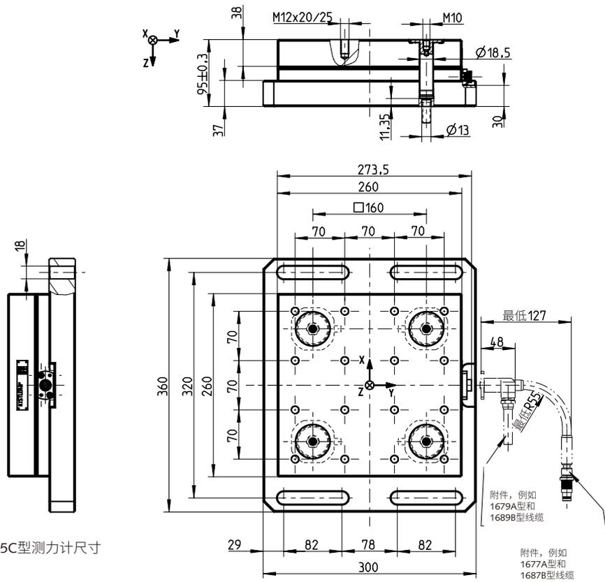
图1: 9255C型测力计尺寸
