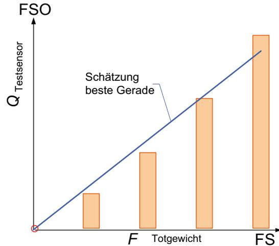
Bild 3: Stufenweise Kalibrierung
