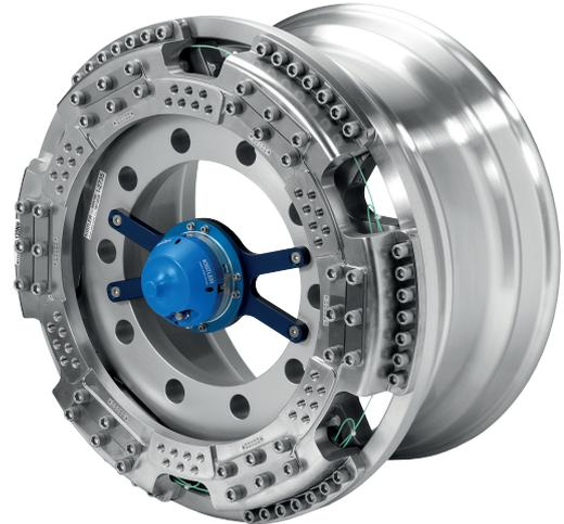
Die Übertragungsmodule lassen sich schnell und leicht untereinander austauschen. Das digitale Telemetriesystem (Typ 9811B) kann neben dem Traktionsmoment  $M_y$  drei Temperatursignale (sowie ein Temperatursignal der Radelektronik) übertragen.
