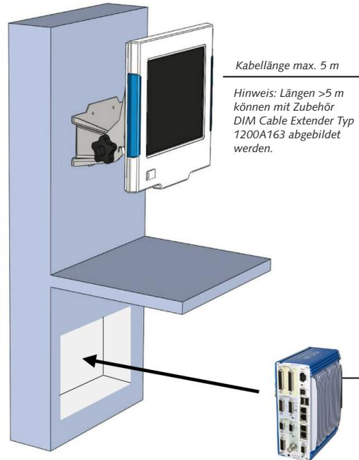
**Funktionsprinzip mit DIM Cable Extender**
