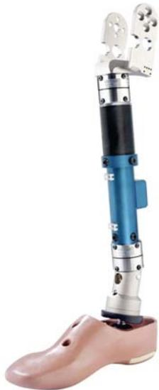
Bild 1: Instrumentiertes Thor LX-Bein
