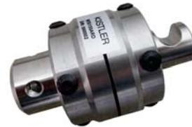
In einer Wheatstonschen Brückenschaltung werden die proportionalen Widerstandsänderungen der einwirkenden Kräfte und Momente gemessen und ausgewertet. Der Sensor ist mit UPS-Modul, das in einem externen Zusatzgehäuse im Kabel oder im Steckverbinder untergebracht ist, erhältlich. Kundenspezifische Kabellängen und Steckverbinder mit spezieller Kundenbelegung sind optional möglich.
