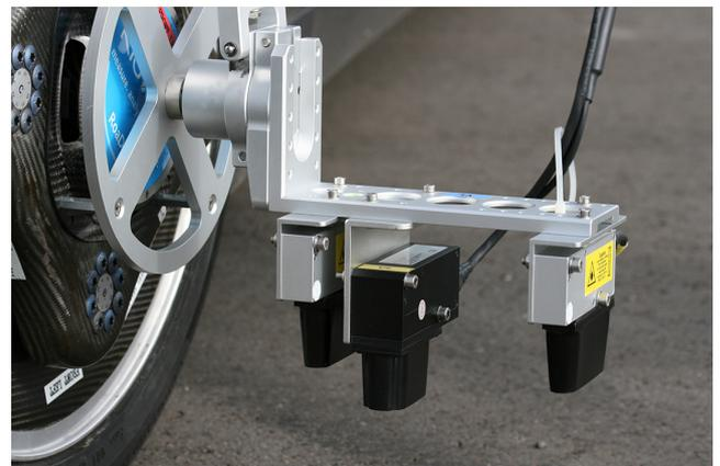
Bild 3: DCA System am RoaDyn S625 CFR Messrad, mit optionalem SFII-P Sensor zur Messung des Schräglaufwinkels
