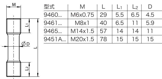
図1: プリローディングボルト 型式9460、9461...、9465...、9451A...
