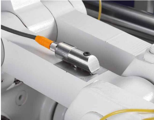
Bild 8: Indirekte Kraftmessung an einem Kniehebel
