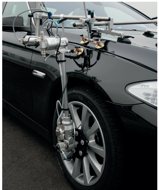
図4: WPTセンサと組み合わせたRV-4センサの前輪取付け
