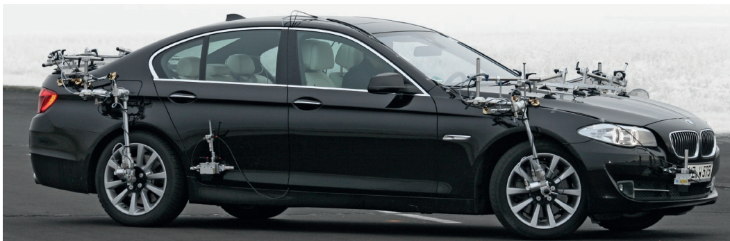
図 5: RV-4センサを車に取付け(2軸測定)
