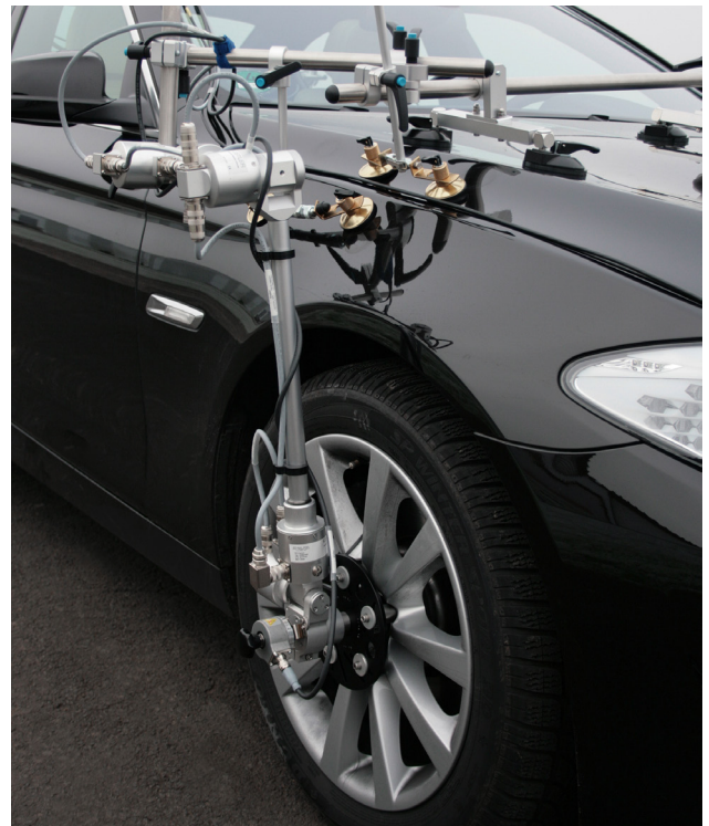
Bild 4: RV-4 Sensor mit optionalem WPT Sensor, Vorderradmontage
