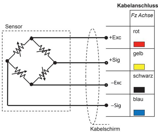
Bild 2: Kabelanschluss
