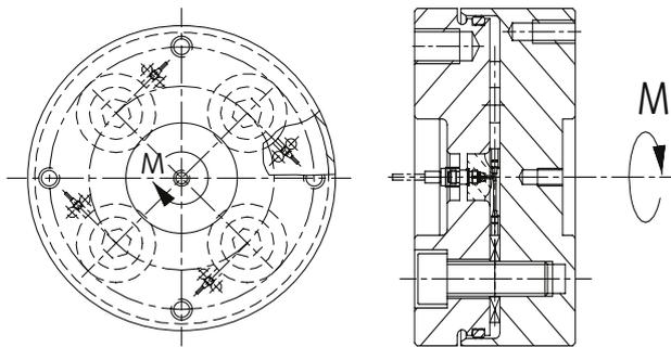
Bild 6: Drehmomentdynamometer. Durch Messen der Schubkräfte  $F_y$  kann das resultierende Drehmoment  $M$  berechnet werden.
