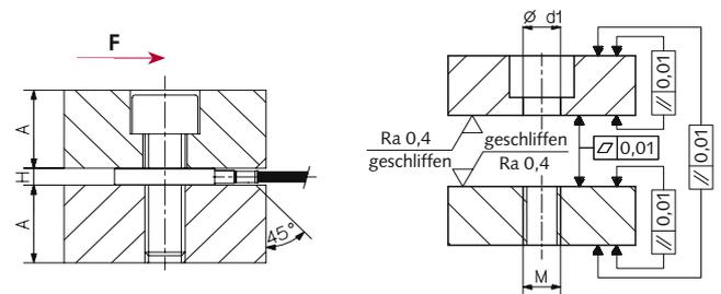
Bild 3: Einbaumasse bei direkter Kraftmessung
