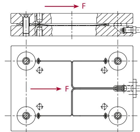
Bild 5: Einkomponenten-Dynamometer. Messen der Schubkräfte F<sub>y</sub>. Anmerkung: Zwei Sensoren müssen um die Steckerachse gedreht montiert werden.
