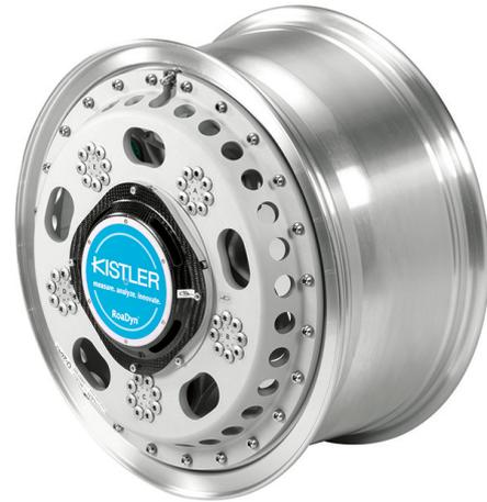
Die Kistler Messräder können sowohl an Fahrzeugen, die auf der Strasse fahren, als auch an Prüfständen, wie z.B. Achsprüfständen oder Fahr simulatoren, eingesetzt werden. Das RoaDyn S6 Messrad von Kistler ist ein hochentwickeltes, modularer und flexibler Sensorverbund. Dadurch ist das Messrad an verschiedenste Anwendungen adaptierbar, auch wenn diese nicht in diesem Dokument aufgeführt sind.
